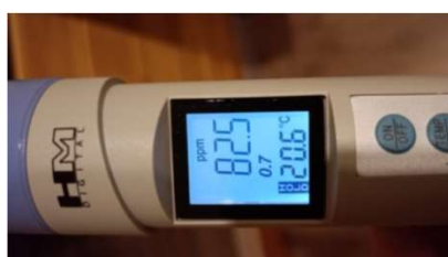
Рисунок 9. TDS метр Digital COM-100, минерализация воды, 1 ppm = 1 мг/л
