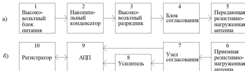
Рисунок 1. Структурная схема георадара «Сфера», а — передатчик, б - приемник
