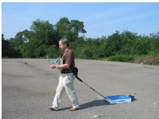
Рисунок 8. Георадар ЗОНД-12 с антенной 300 МГц.
