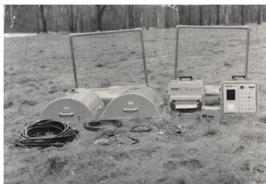
Рисунок 2. Подповерхностный радиолокатор YL-R2 производства корпорации OYO, Япония.
